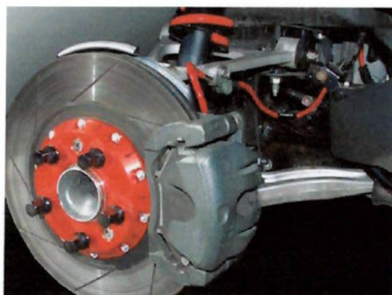
Figura 5 – Freio a disco em veículo [9]
