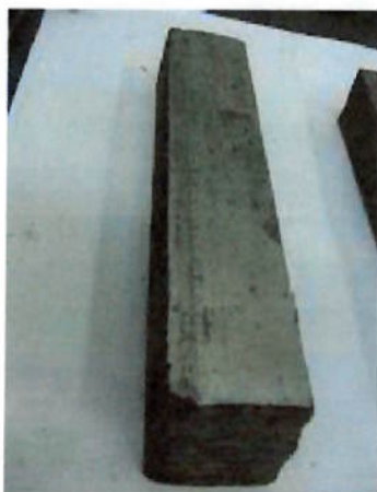
Figura 17 – Material com problema (heterogeneidade na dureza)
